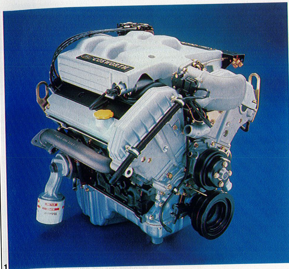
1. Le V6 Ford Cosworth 24 soupapes a une allure nettement plus moderne que le moteur standard. On remarquera la présence d'un refroidisseur et le montage en dérivation de la cartouche de filtre, pour des raisons d'encombrement.
