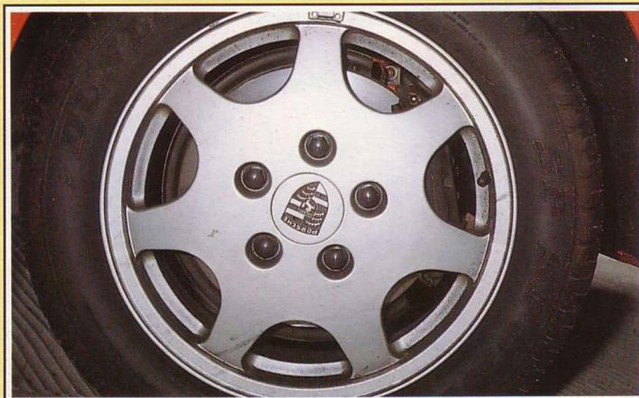
**Les jantes en alliage anti-salissures cachent les disques ventilés de 282 mm à l'avant et les magnifiques étriers Brembo à 4 pistons marqués Porsche.**
