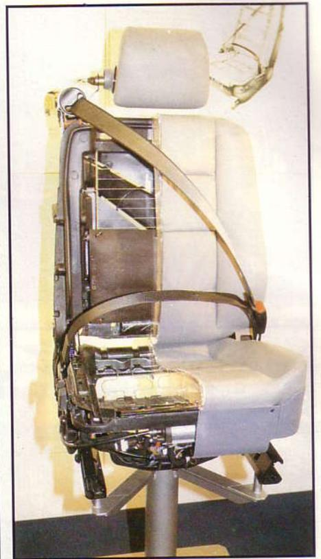
**Siège avec système de ceinture intégré et réglage automatique de l'appui-tête et du point d'ancrage supérieur, en fonction de la hauteur choisie.**
