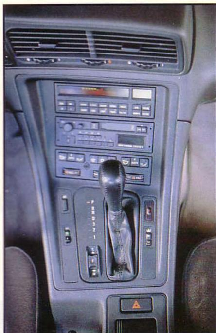
**1. Une console garnie, avec un visuel multi-informations en haut. Au centre, le levier de la boîte automatique, avec le sélecteur de programmes. A gauche, en haut, le contacteur de l'ASC et en bas, celui de l'EDC.**
