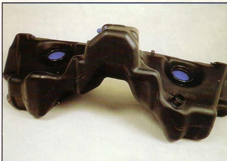
▲ Le réservoir en plastique est disposé devant l'essieu, de chaque côté de l'arbre de transmission en-dessous des places arrière.
