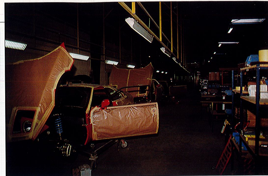
On assemble très soigneusement 4 voitures par semaine. Les coques sorties de l'ultime stade de peinture reçoivent leur mécanique.
