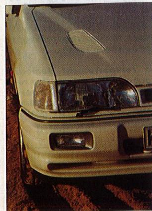
Le capot comporte deux rangées d'ovies d'aération : un côté turbo, l'autre côté rampe d'injection.
