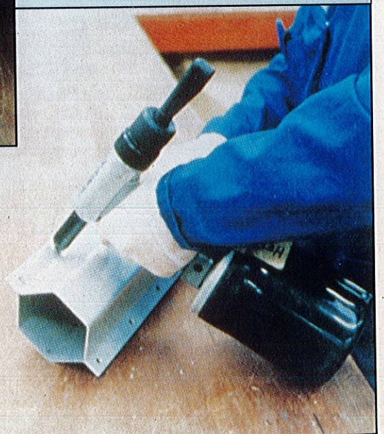
L'encollage des tôles. La colle est appliquée à la main (en haut) ou à l'aide d'un pistolet à jet (à droite), mais le processus peut être facilement automatisé à l'aide d'un petit robot semblable à ceux utilisés pour étendre les joints d'étanchéité dans les moteurs. En bas, le dispositif d'assemblage.
