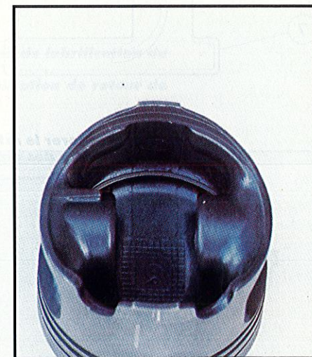
Pour limiter les dilatations de la jupe et les rendre plus uniformes, deux inserts en acier (dont le coefficient de dilatation est très inférieur à celui de l'aluminium) sont insérés dans l'alliage. Un des inserts est bien visible sur la photo.
