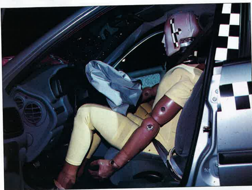
Les mannequins sont équipés de capteurs de force et d'accélération enregistrant le déroulement de la collision. Prix d'un Hybrid III : 700 000 F. On notera ici la trace laissée par l'impact de la tête du mannequin, bien au centre de l'air bag
