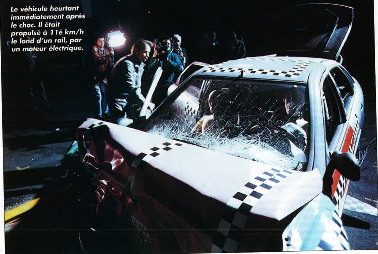
Les mannequins sont équipés de capteurs de force et d'accélération enregistrant le déroulement de la collision. Prix d'un Hybrid III : 700 000 F. On notera ici la trace laissée par l'impact de la tête du mannequin, bien au centre de l'air bag
