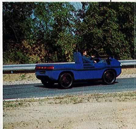
Dès que les roues sont en contact avec le sol, le conducteur enclenche une vitesse, ce qui désactive aussitôt la propulsion par hydrojets.
