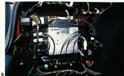
6 **Détail du bloc de commande logé dans l'aile arrière. Le groupe motocompresseur intègre cinq électrovannes, soit une de charge pour chaque coussin, plus une de décharge pour l'ensemble. La pression distribuée varie selon les conditions de 1,5 à 8,5 bars. Les vitesses de montée du véhicule sont de**
