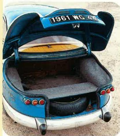
Pratique : l'accès à la roue de secours ne nécessite pas de sortir les valises du vaste coffre en cas de crevaison.
