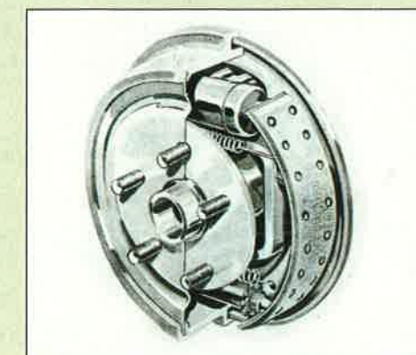
Les freins « auto-énergétiques » utilisent la lancée de la voiture pour renforcer le freinage.
