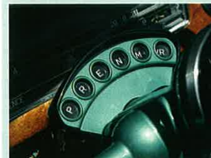
Derrière le volant, une console reçoit les voyants de sélection de la transmission Transfluide.
