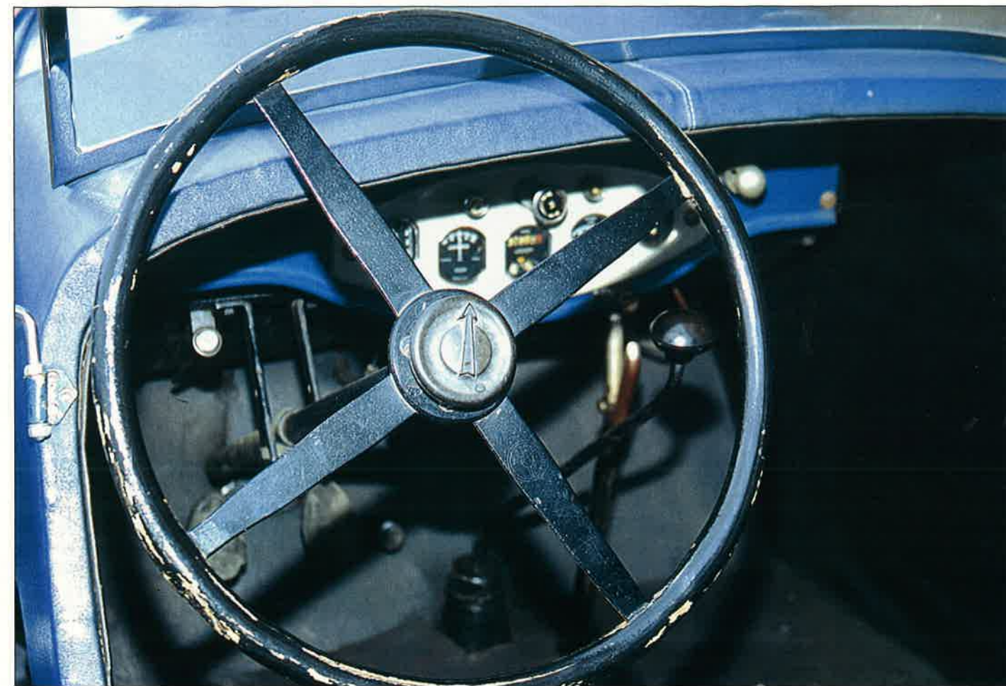
La pédale d'accélérateur dérouta le conducteur du XX e siècle puisqu'elle est de la taille d'un champignon nain ! Le diagramme de la boîte de vitesses demeure classique, 1 re à gauche vers le conducteur, 2 e à droite en haut et 3 e en droite en bas.
