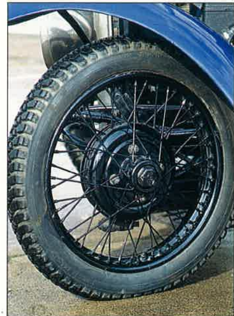
Aujourd'hui, comme sur certains documents d'époque et contrairement à l'offre de série, la 301 des records repose sur de gracieuses roues fils. Le rayon de braquage varie de 5,60 à 6 mètres, suivant les modèles 1932.
