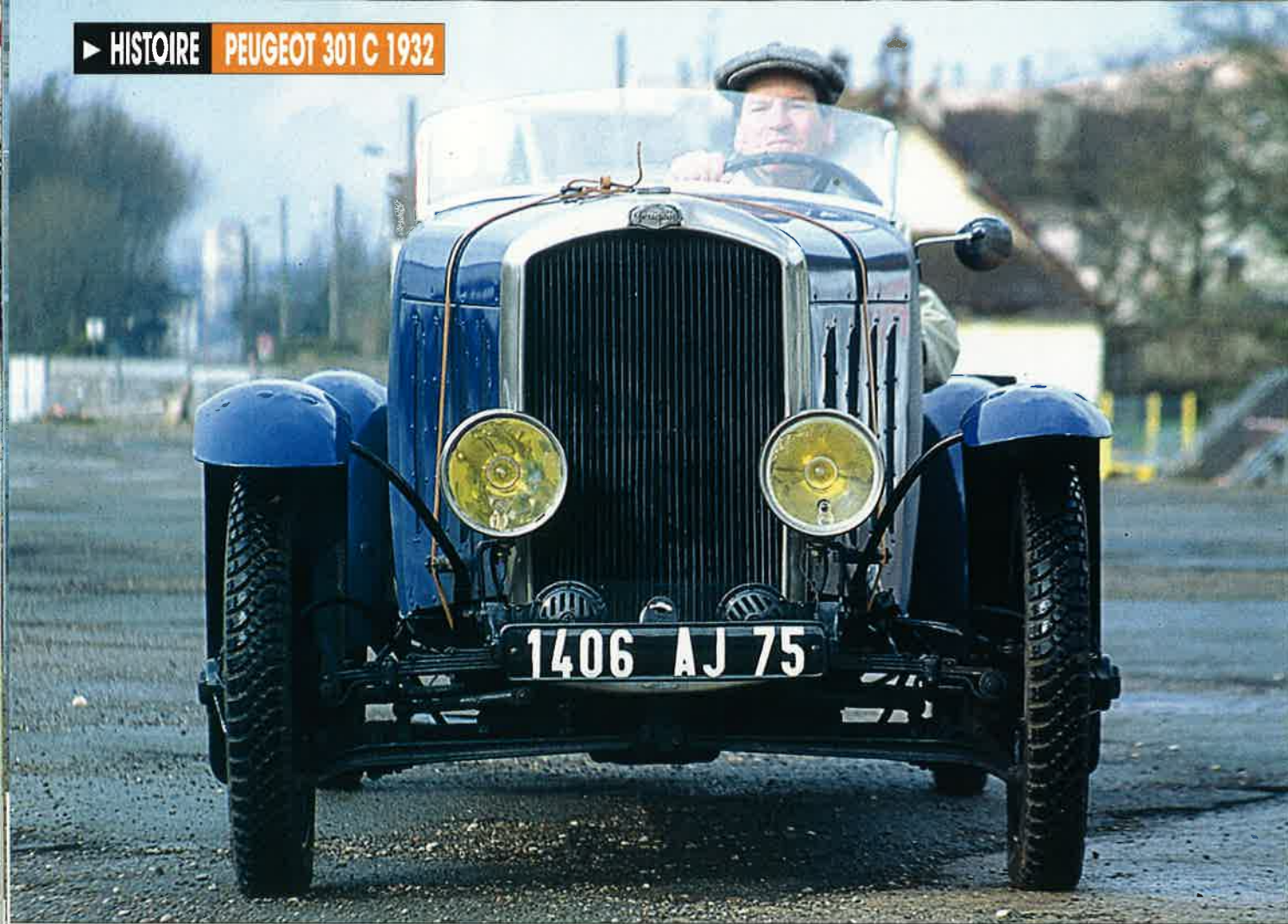
L'absence de pare-chocs sur la 301 des records permet d'observer plus librement le système de suspension avant à lames transversales et deux tirants articulés au centre, et les supports de roues avant indépendantes. Un équipement peu courant sur une automobile de série en 1932, déjà éprouvé sur la 201 Confort.
