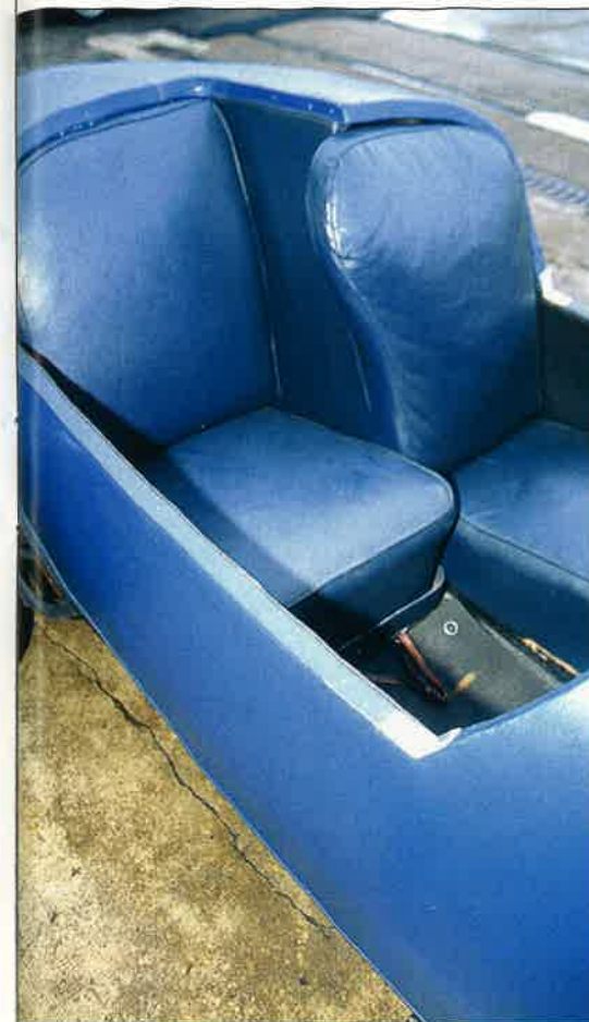
Cette vue plongeante du poste de pilotage indique que la voiture est prévue pour deux passagers, la place de droite étant en position décalée. Durant l'épreuve, cette surface alors inutile est couverte d'un tendelet en simili cuir.
