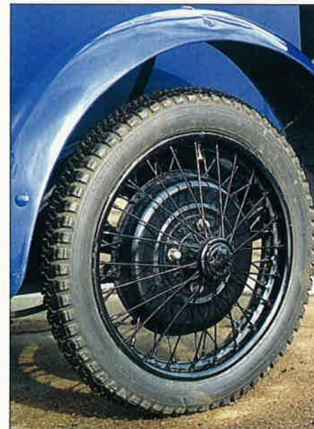
Aujourd'hui, comme sur certains documents d'époque et contrairement à l'offre de série, la 301 des records repose sur de gracieuses roues fils. Le rayon de braquage varie de 5,60 à 6 mètres, suivant les modèles 1932.
