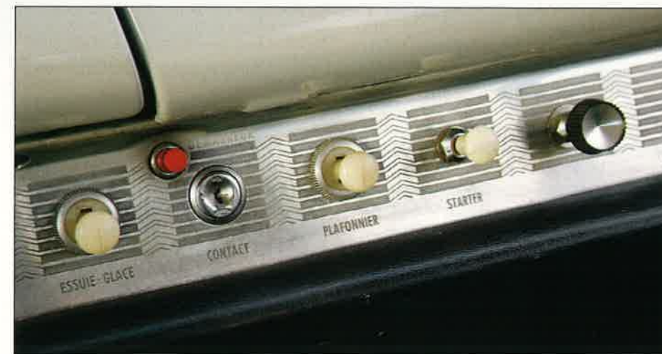
Les boutons de commande sont parfaitement identifiés par des inscriptions. Notez le bouton-poussoir rouge de démarreur, à côté de la clé de contact.
