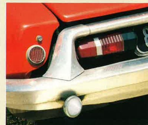
Notez le catadioptré rond monté sur ces premières ID à « ailes courtes ». Le feu de recul blanc est un accessoire monté par le propriétaire.
