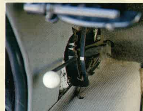
Comme sur la DS, le levier de réglage de la hauteur de caisse est placé à gauche près du pédalier.
