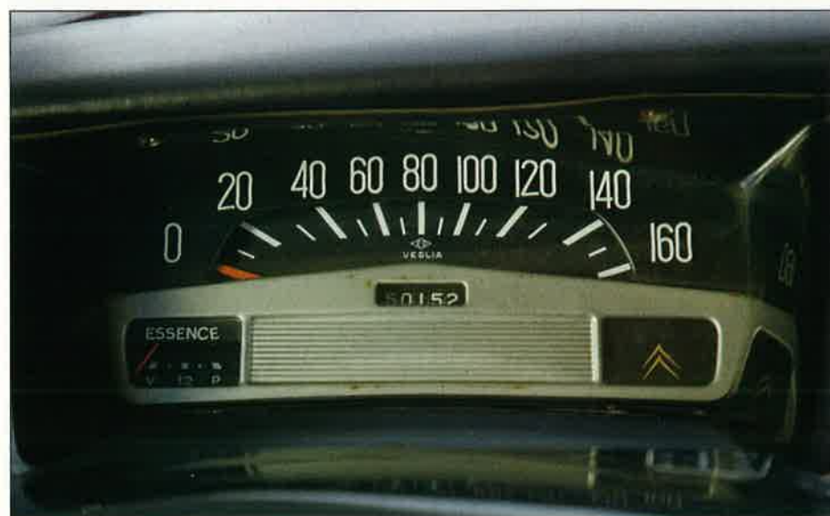
Spartiate, le compteur ! Juste l'indication de la vitesse et la jauge d'essence ! Il n'y a même pas de thermomètre d'eau ou de voyant d'huile !
