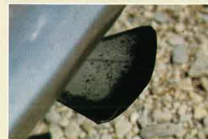
Pour d'obscures raisons, cette ID19 est équipée d'un échappement à sortie centrale en « queue de carpe », identique à ceux montés sur les DS jusqu'en 1958. Normalement, l'ID est dotée d'un échappement sortant à gauche.
