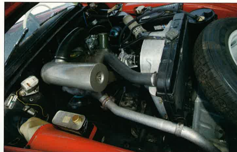
Dissimulé par la roue de secours, le 4 cylindres de l'ID 19 utilise un carburateur simple corps et perd les nombreuses assistances hydrauliques de la DS, pour le plus grand bonheur de certains utilisateurs et... des mécaniciens !
