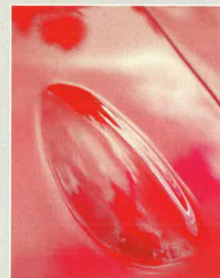
Le petit bossage sur le capot avant est dû à l'arrivée, en 1970, d'un servo-frein placé dans le coffre.
