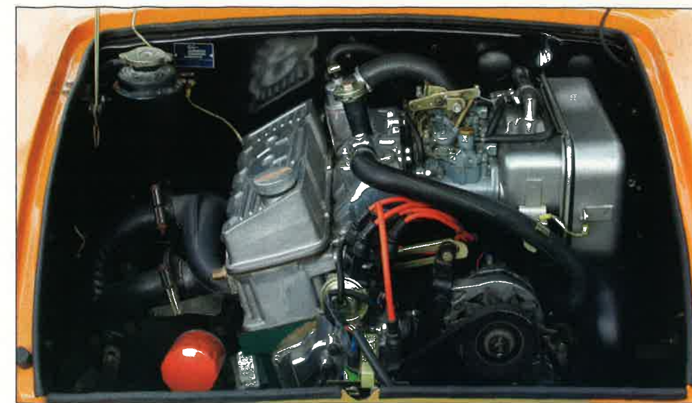
Loger le moteur du coupé Simca 1200 S à l'arrière de la CG ne posait pas beaucoup de difficultés. La seule modification vient du pan coupé sur l'angle du filtre à air.
