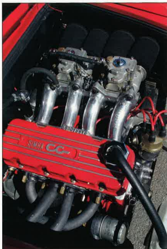
Si Michel Tapie est le plus connu des préparateurs moteurs des CG, Barraquet n'en reste pas moins un maître en la matière. Ici, la préparation offre environ 35 CV supplémentaires.
