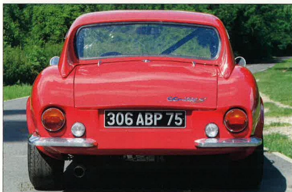
On reconnaît les feux arrière du coupé Simca 1000, en revanche, les échappements affichent la présence d'une mécanique plus poussée. En bas, la préparation Barraquet jouait sur le moteur et l'échappement.
