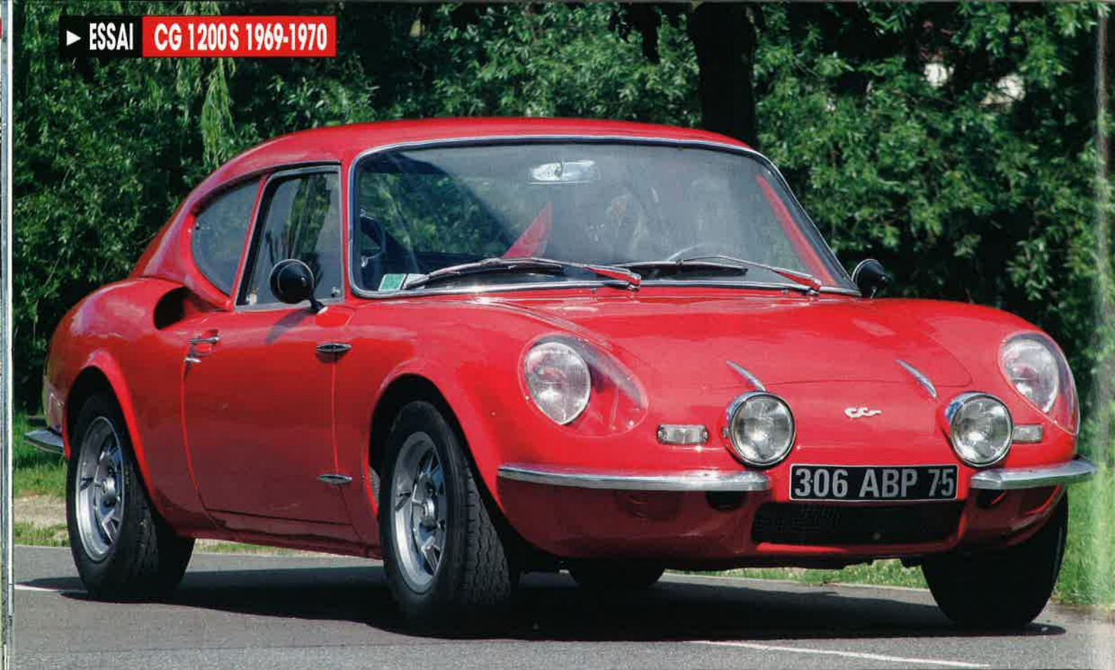
La face avant des 1200 S ressemble étrangement à celle des Berlinette. La fine prise d'air logée sous la plaque d'immatriculation alimente le radiateur situé à l'avant.
