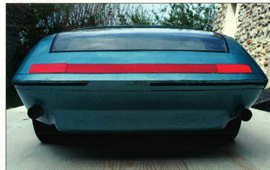
Deux sorties d'échappement (un par rangée de cylindres) sont disposées de part et d'autre du pare-chocs arrière, déjà monobloc, intégré à la carrosserie.
