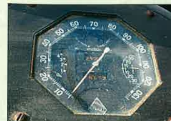
Le compteur octogonal remonte aux Renault d'avant-guerre ! Outre la vitesse (135 km/h !), il indique le niveau de carburant et la charge de la batterie.
