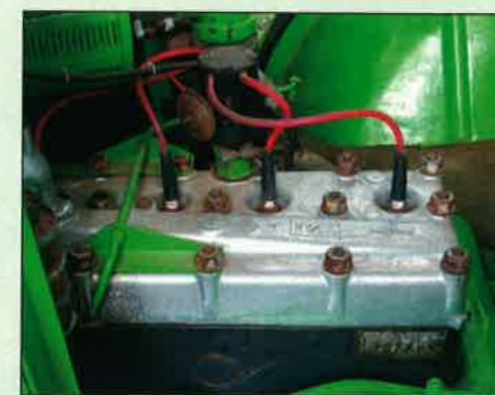
Placé en porte-à-faux avant, le 4 cylindres latéral type 85 provient directement de la Vivaquatre ! Cet héritage d'avant-guerre est également monté sur les premières Colorale.
