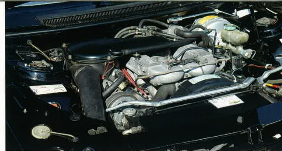
Le moteur de cette 604 STI Chapron est le moteur 6 cylindres PRV de 15 CV disposant du système d'injection Bosch K Jetronic.
