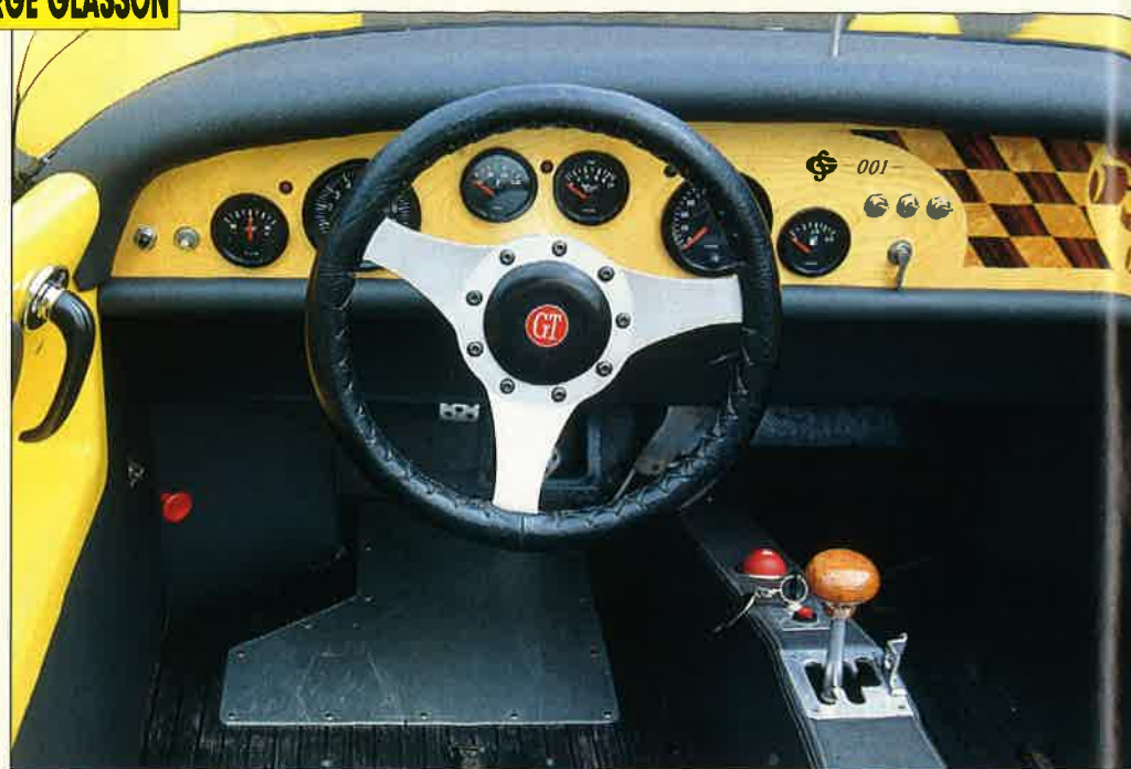
Le tableau de bord s'est modernisé, le volant à changé lui aussi et Serge a installé une planche en bois marquée. On remarque sur cette planche de bord, à droite du volant, les initiales de Serge Glasson et le numéro d'ordre 001.
