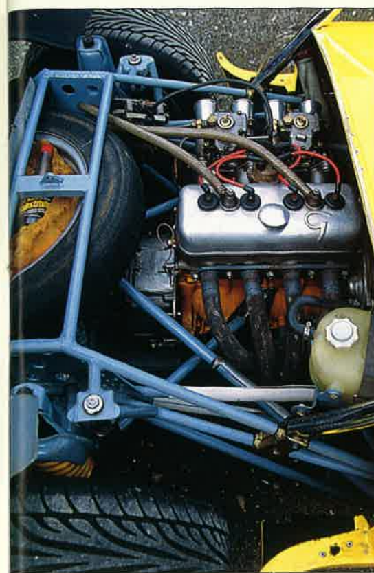
Finalement, après plusieurs moteurs Renault, c'est un 1296 Gordini qui tient bien son rôle en position centrale.
