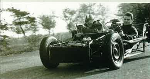
Premiers essais en châssis pour la Glasson spéciale. Moteur de Dauphine Gordini et cheveux au vent.
