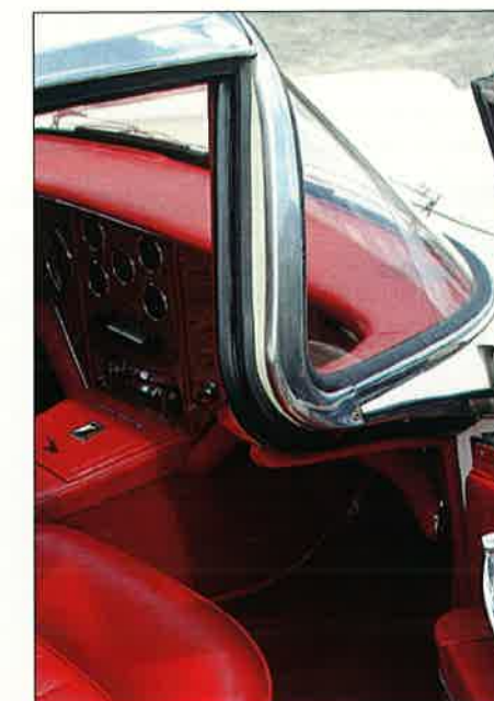
La forme inférieure, exagérément rentrante, du pare-brise panoramique gêne la pénétration au sein de l'habitacle.
