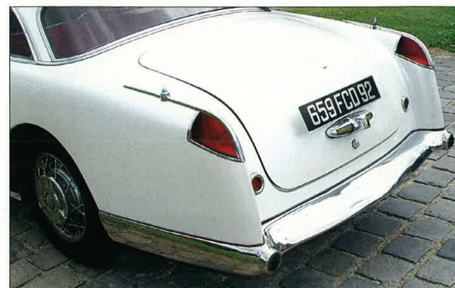
Les roues à rayons adoptent un enjoliveur comprenant un faux papillon de serrage. Les embouts d'échappement logés dans les pare-chocs reprennent une idée lancée par Cadillac dès 1952. Le dessin des feux arrière, parfaitement intégrés dans les lignes de la voiture, demeure un exemple dans l'histoire du stylisme automobile.
