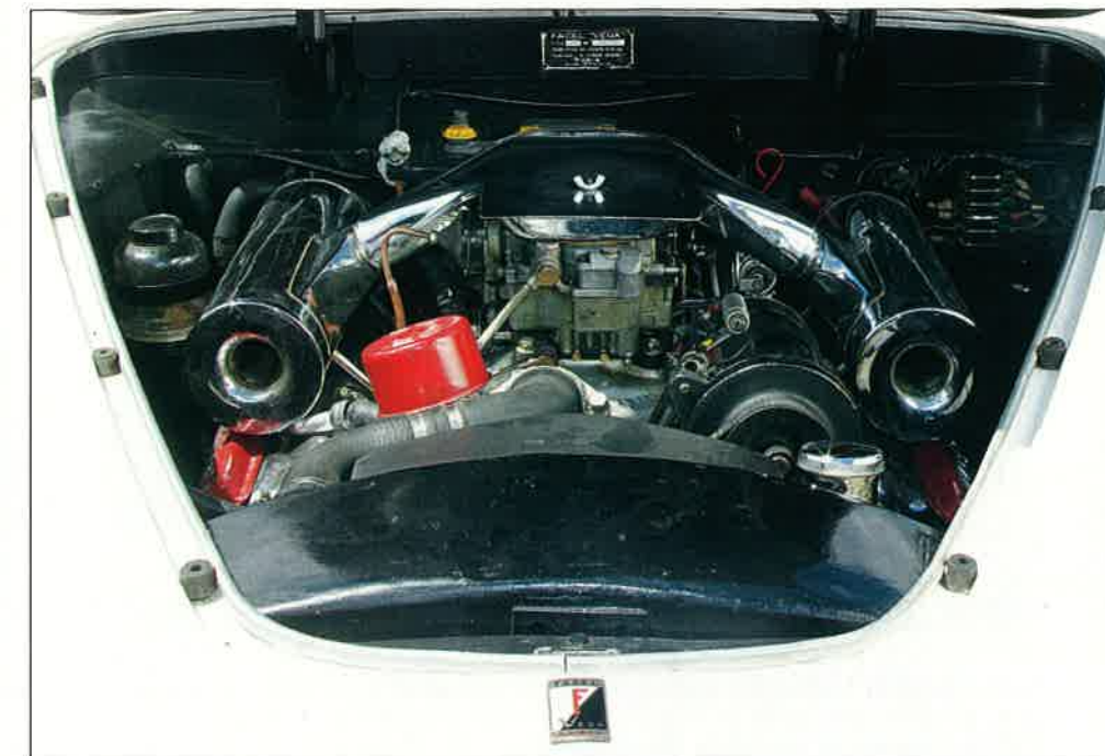
Jeter son dévolu sur des mécaniques d'origine Chrysler à huit cylindres en V aux culasses hémisphériques s'avère très judicieux de la part de Jean Daninos. Il s'agit de groupes puissants, souple et fiable, d'une très bonne réputation sur les routes du monde entier.
