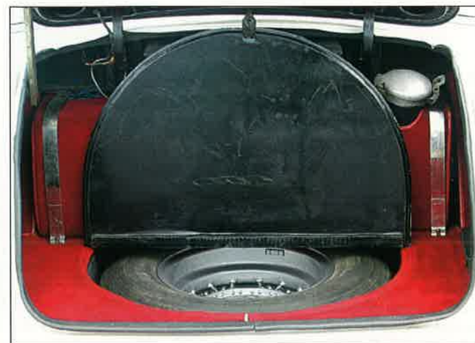
Non seulement le réservoir de carburant occupe une (trop) grande place au sein de l'espace à bagages, mais son remplissage mal placé risque de tacher les précieuses valises des voyageurs. La roue de secours sous le plancher n'est pas non plus très pratique, la boîte noire au sommet est la trousse à outils d'origine.
