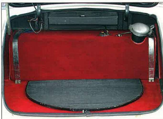
Non seulement le réservoir de carburant occupe une (trop) grande place au sein de l'espace à bagages, mais son remplissage mal placé risque de tacher les précieuses valises des voyageurs. La roue de secours sous le plancher n'est pas non plus très pratique, la boîte noire au sommet est la trousse à outils d'origine.
