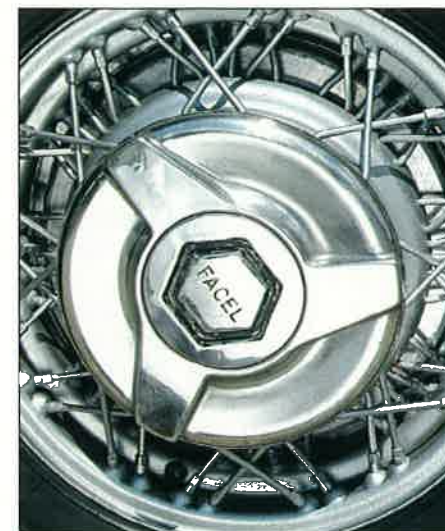
Les roues à rayons adoptent un enjoliveur comprenant un faux papillon de serrage. Les embouts d'échappement logés dans les pare-chocs reprennent une idée lancée par Cadillac dès 1952. Le dessin des feux arrière, parfaitement intégrés dans les lignes de la voiture, demeure un exemple dans l'histoire du stylisme automobile.
