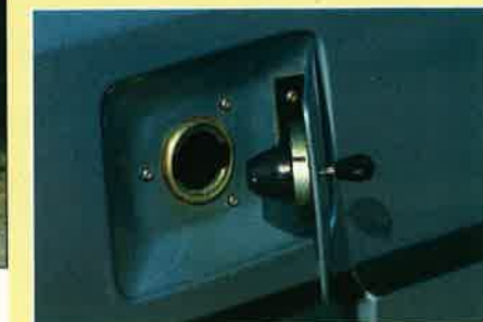
Caractéristique de la BX, le bouchon de réservoir est solidaire de la trappe que l'on ouvre à la clé.
