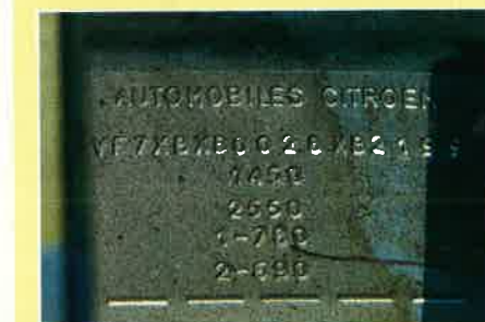
...Tout comme la plaque constructeur sur laquelle figurent le type et le numéro de série.
