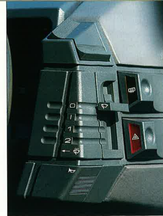
Les fameux commodos que l'on pianote du bout des doigts. À gauche du volant, ils commandent les essuie-glaces et le klaxon.
