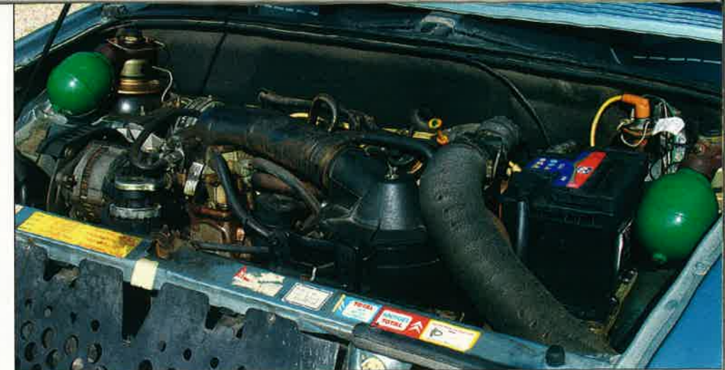
La BX 16 RS est animée par le tout nouveau moteur de 1 580 cm 3 doté d'une courroie crantée et délivrant 94 ch. Celui-ci sort à peine de rodage !
