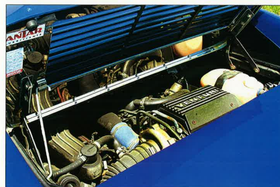
L'accessibilité mécanique reste problématique à cause de la position centrale du moteur et de la présence d'un coffre tout à l'arrière. Notez la coiffe du système de suralimentation griffé Venturi.
