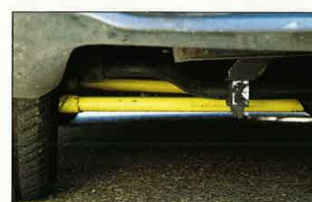
La Venturi 260 Atlantique a une particularité : son train arrière multibras, un modèle « sportif » tourné vers le circuit. On le reconnaît grâce aux suspensions constituées de bras jaunes.
