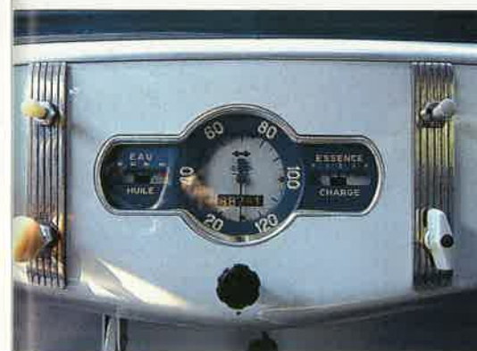
Le compteur à oreilles monté en série, à partir de février 1953. En bas à droite, la commande du démarreur. Il n'y a jamais eu de contact à clé de série sur aucune Juva. Ci-dessous : la porte arrière présente son nouveau sens d'ouverture.
