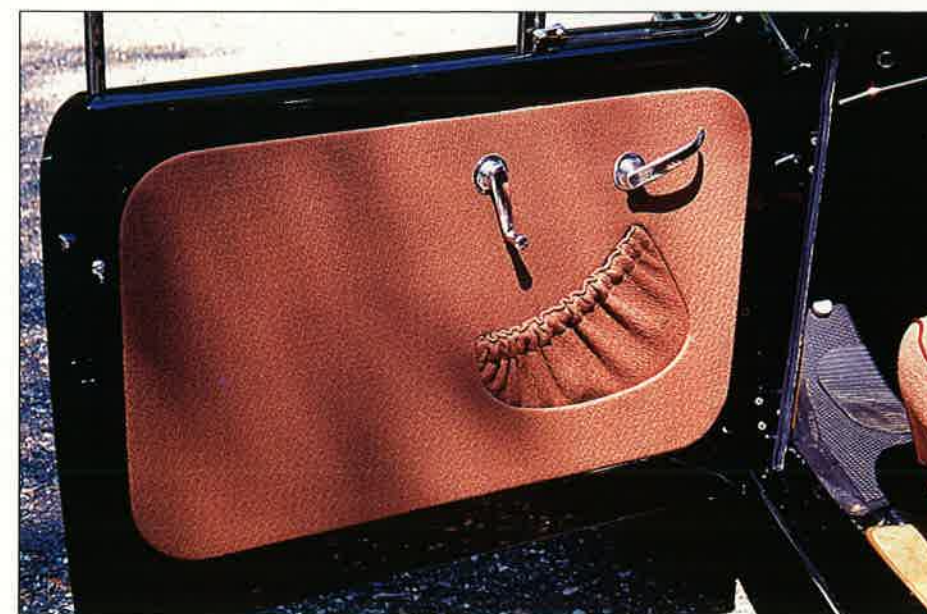
Il n'y a pas de serrure sur la porte conducteur, un simple loquet permet le verrouillage par l'intérieur, et cela sur tous les modèles.
