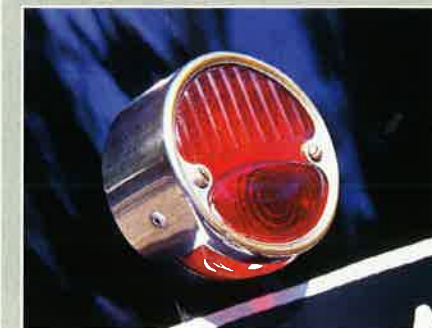
Un seul feu à l'arrière, trois fonctions : stop, lanterne et éclairage de plaque !
