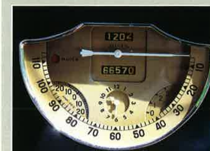
L'élégant tableau de bord Jaeger coquille inversée, bitotalisateur avec montre pour cette Juvaquatre grand luxe.
