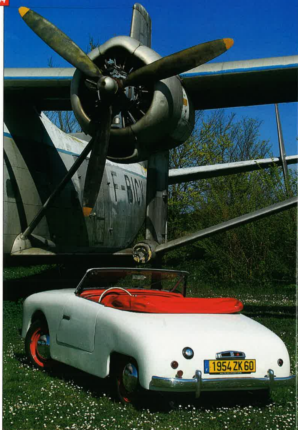
L'éclairage de plaque arrondie est remplacé, en 1954, par un bloc allongé, moins élégant mais plus efficace.
