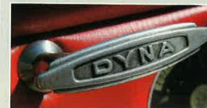
Le frein à main (identique à celui de la Dyna) se loge sur la planche de bord.
