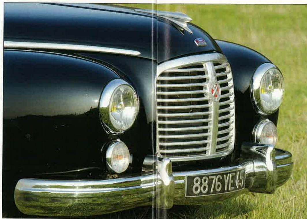
Sous les phares, la Hotchkiss-Grégoire dispose d'un anti brouillard et d'un phare de pointe. Sur la voiture de Jacques Paquereau, ils servent aujourd'hui de cligno tants, « bien plus utiles pour la circulation actuelle ».
