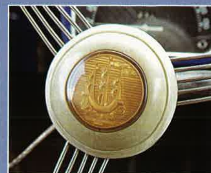
Le volant Quillery à branches métalliques souples est un accessoire couramment monté sur les voitures françaises.
