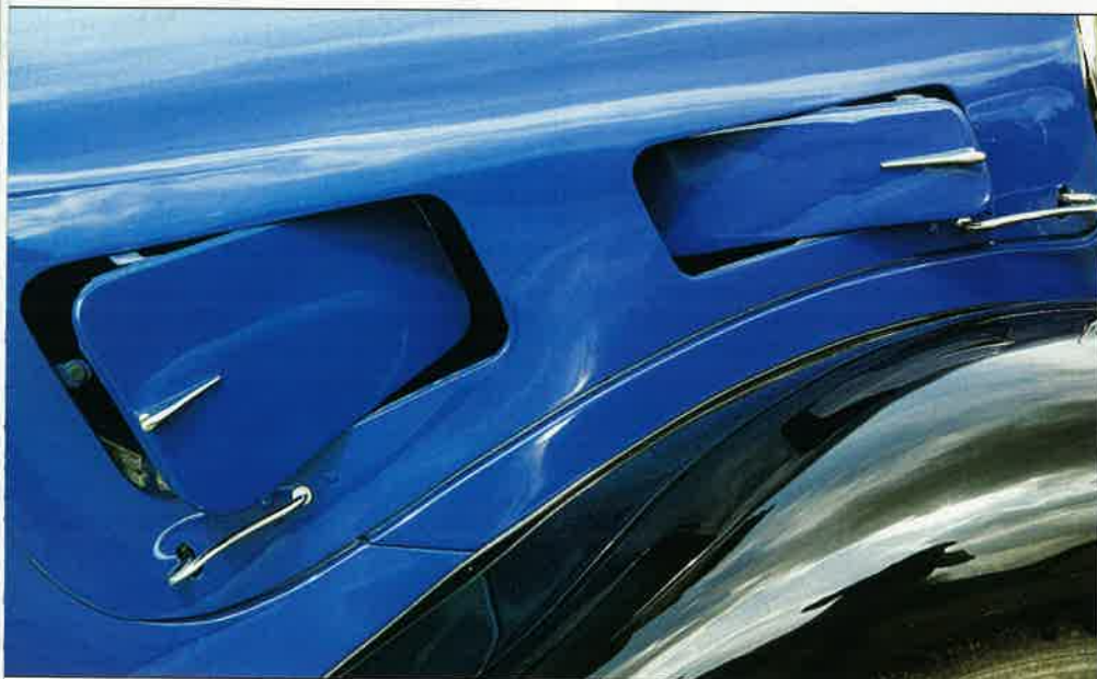
Pour une aération et une évacuation de l'air chaud optimales, les volets de capot ont une ouverture antagoniste.
