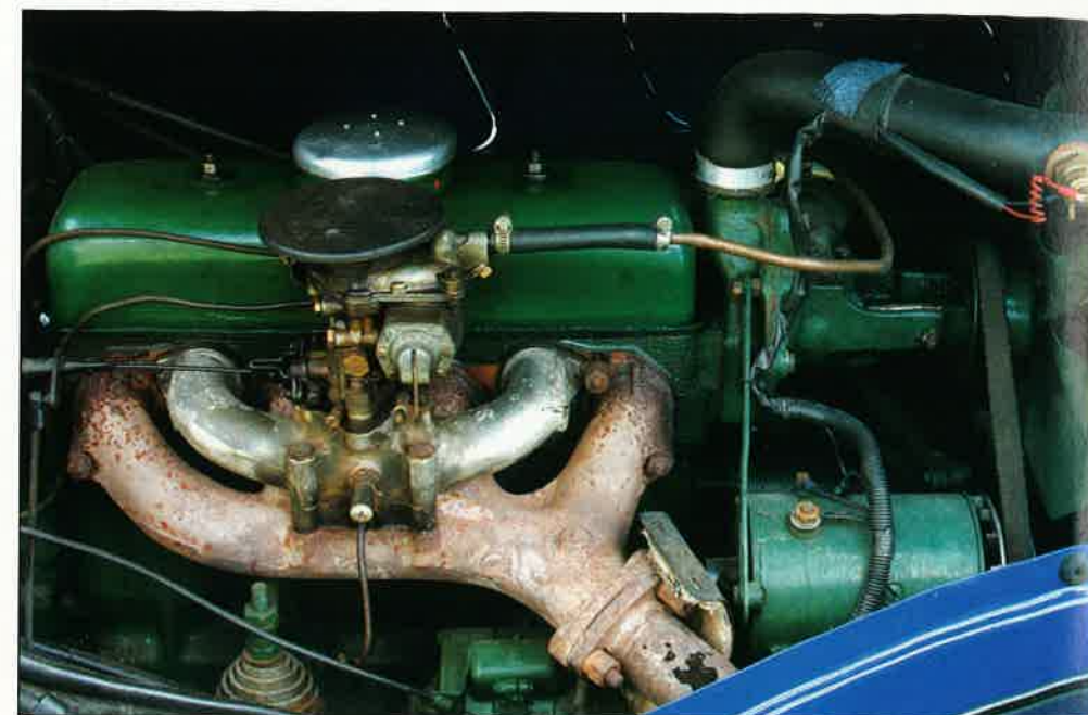
Seule modification consentie par notre collectionneur pour gagner un peu de puissance : le montage d'une tubulure de 11 de 1938 et d'un carburateur Solex vertical.
