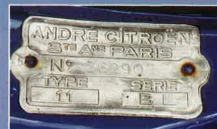
La plaque constructeur est apposée sous le capot moteur côté droit.
