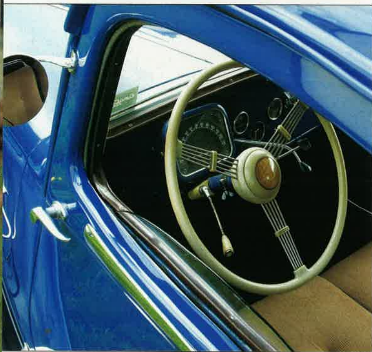
Le tableau de bord est identique à celui des Traction du millésime 1937. Notez, à gauche du volant Quillery, la tige de la commande d'avance à l'allumage.
