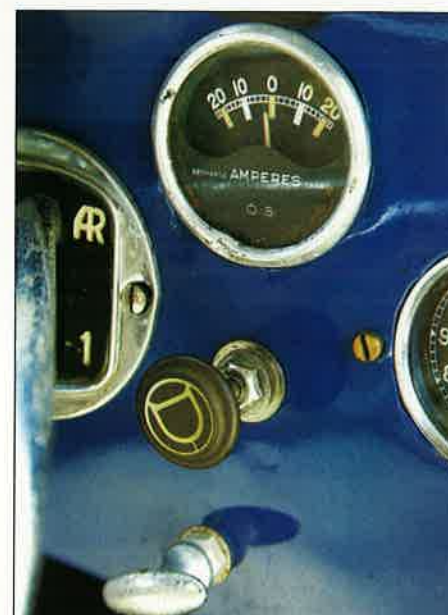
Parmi les manomètres couramment montés comme accessoires, on trouve cet ampèremètre, au-dessus de la montre d'origine.
