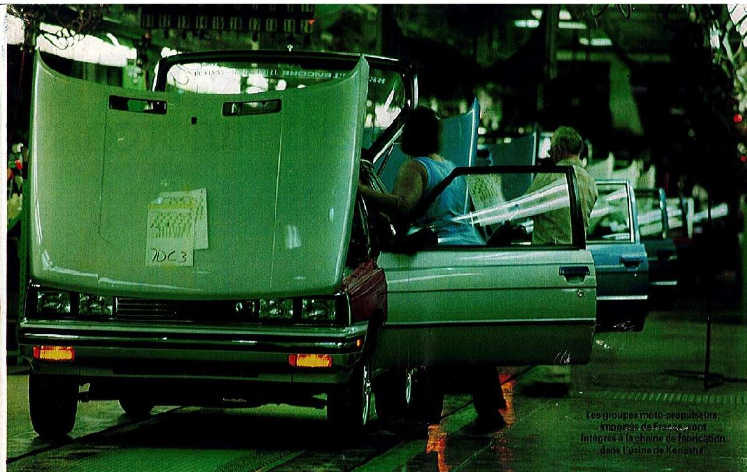
Les groupes moto-propulseurs importés de France sont intégrés à la chaîne de fabrication dans l'usine de Kenosha.
