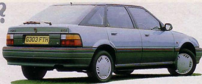
**R**over amorce donc un retour en force dans le domaine mécanique avec un 1 400 cm<sup>3</sup>, 16 soupapes double arbre à cames en tête, délivrant 95 ch à 6 250 tr/mn, et accouplé à la boîte de vitesses PSA des AX et 205. Il offre une puissance honorable pour le bas de gamme, la 214, qui se décline en trois niveaux de finition : Si, SLi et GSi. Ce moteur sera prochainement monté sur les futures « Metro », avec 8 soupapes, puis réduit à 1 100 cm<sup>3</sup>.
