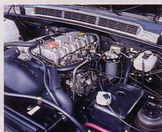
2.5 litres turbo diesel : 121 ch
