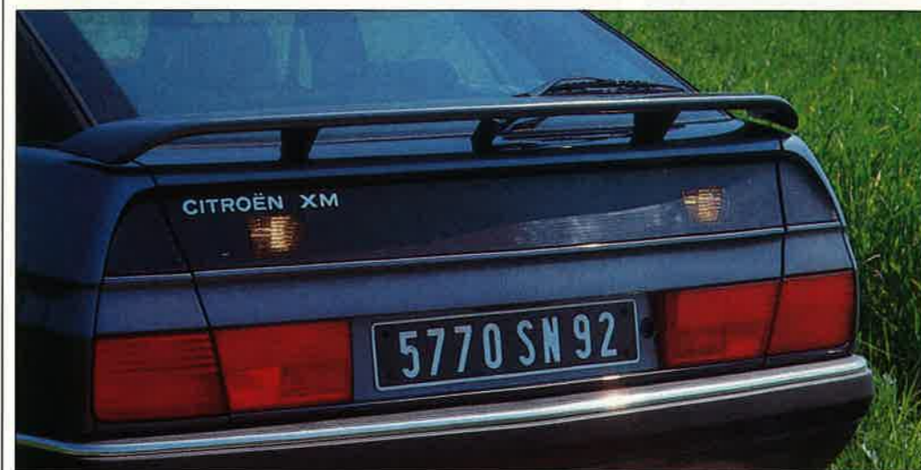
La courbure inhabituelle des vitres a imposé ces montants pas trop esthétiques...
