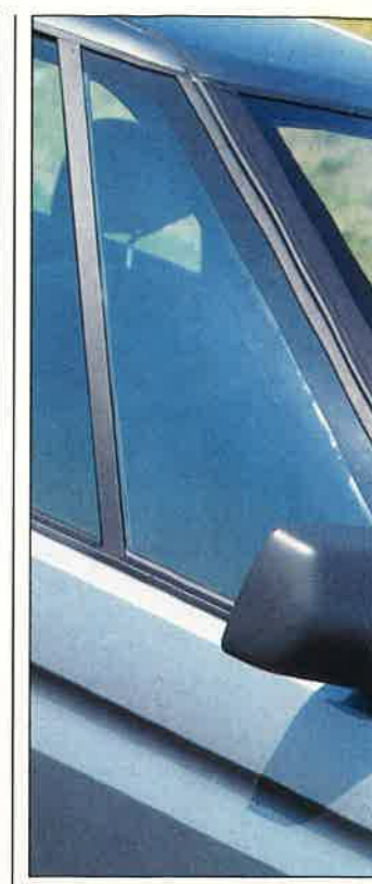
La courbure inhabituelle des vitres a imposé ces montants pas trop esthétiques...
