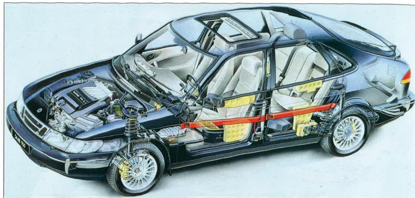
*Moteur transversal, jambes de force triangulées à l'avant et essieu torsionnel AR. La nouvelle 900 adopte un schéma classique. Le moteur est légèrement incliné vers l'avant. Le Cx est de 0,32 et la portance sur l'arrière a été diminuée de 45%.*
