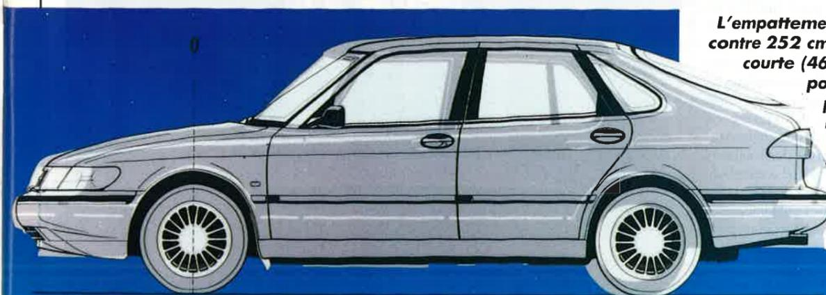
*L'empattement est plus long (260 contre 252 cm) et la longueur plus courte (464 contre 469 cm). Le porte à faux avant n'a pas changé pour des raisons d'absorption tandis que l'arrière est réduit de 1" cm. La voiture est plus large de 16 mm et légèrement plus haute.*
