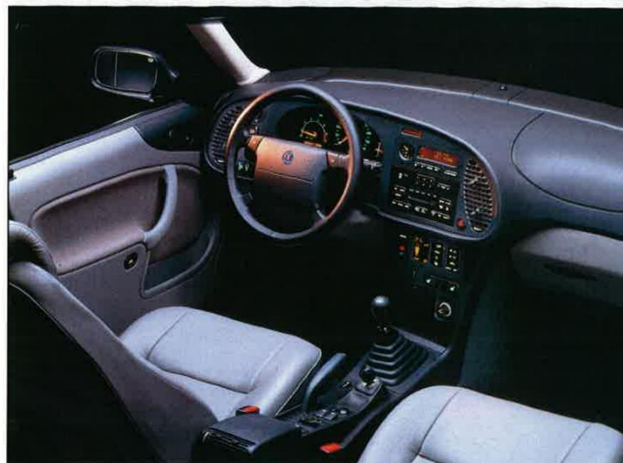
*Planche de bord typique. En version SE, on dispose d'une fonction "Black Panel" qui permet d'éteindre tous les compteurs, à l'exception du tachymètre. Un système électronique fera fonctionner un indicateur donné que si le conducteur a besoin d'être informé.*
