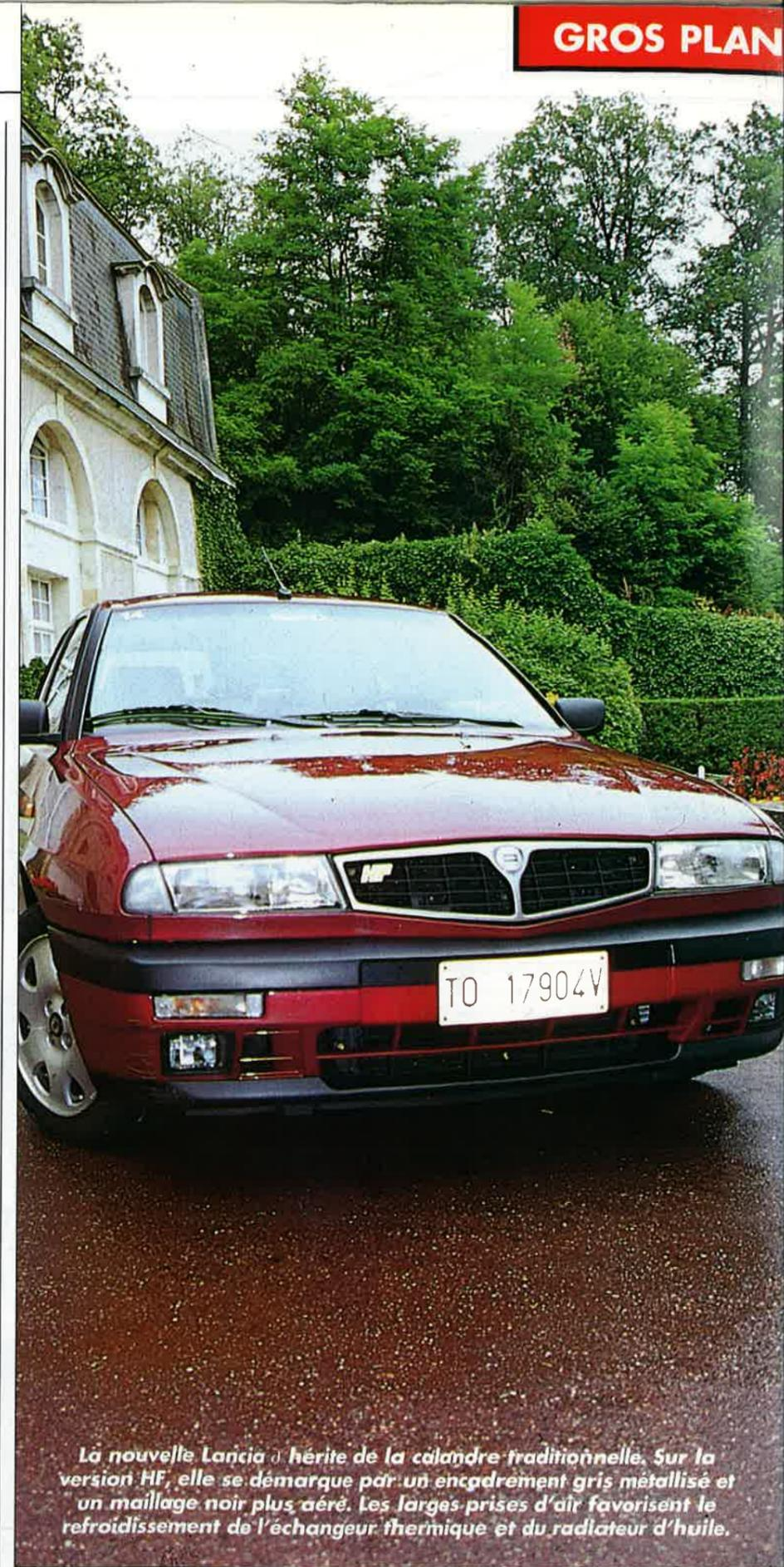
La nouvelle Lancia  $\delta$  hérite de la calandre traditionnelle. Sur la version HF, elle se démarque par un encadrement gris métallisé et un maillage noir plus aéré. Les larges prises d'air favorisent le refroidissement de l'échangeur thermique et du radiateur d'huile.
