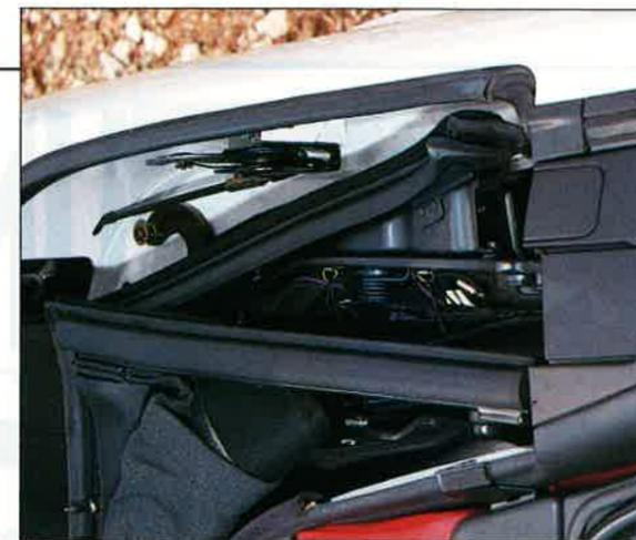
Le système de capote automatique proposé en option ne fonctionne qu'en dessous de 5 km/h ou à l'arrêt. La lunette arrière est désembuée par un ventilateur d'air chaud. Un hard top est également disponible. Entièrement en aluminium, il ne pèse que 29 kg.
