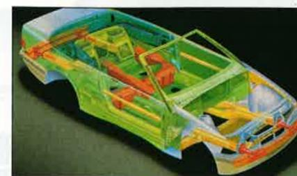
Détail de la coque avec ses renforts. On distingue les deux puits des arceaux de sécurité à l'arrière.
