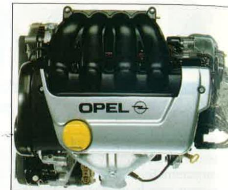
Le nouveau moteur 1.6 16 V avec son collecteur en polypropylène développe 109 ch avec un couple de 15 mdaN à 3800 tr/mn. Il possède une injection séquentielle avec des injecteurs à double jet. Le catalyseur est de type métallique et ses bougies à deux électrodes ont une longévité qui atteint 60 000 km.
