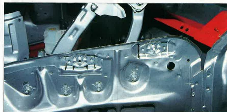
**La doublure d'aile est particulièrement travaillée au niveau du pare-brise ceci afin de se déformer plus facilement en cas de choc avec un piéton. C'est en effet à cet endroit que la tête vient percuter la carrosserie d'où la présence des 2 zones striées.**
