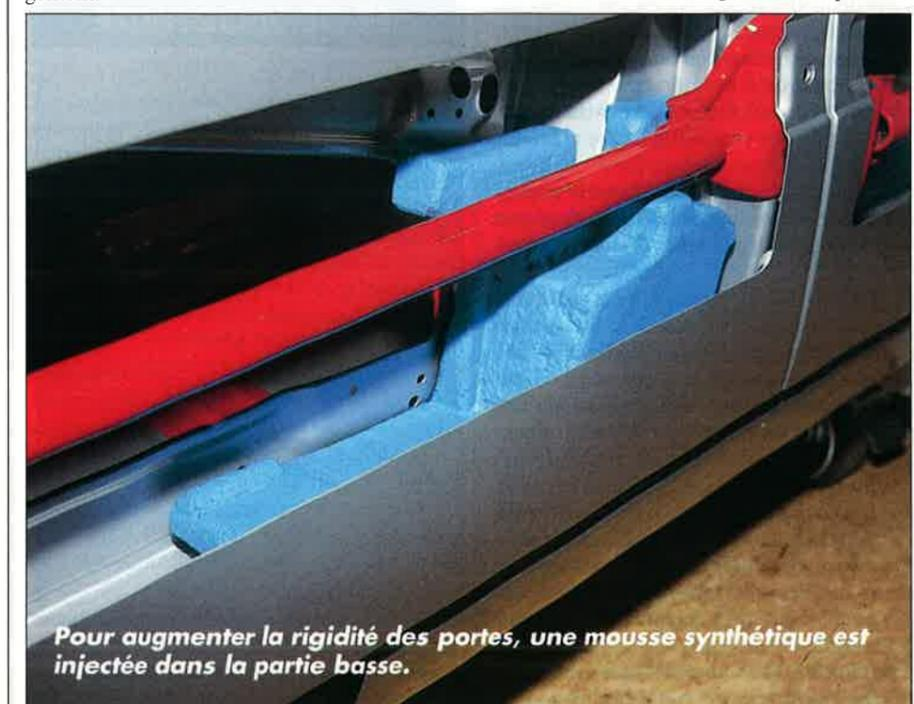
Pour augmenter la rigidité des portes, une mousse synthétique est injectée dans la partie basse.
