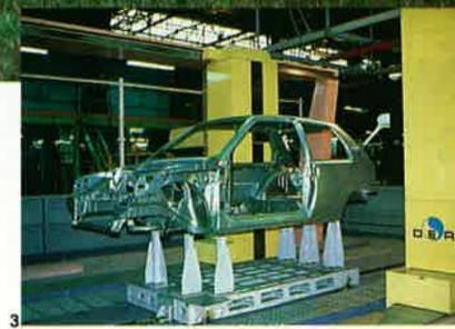
4. Les éléments de renforcement de la structure sont parfaitement visibles ici. L'énergie d'un choc frontal peut être "dissipée" sur tout le châssis.
