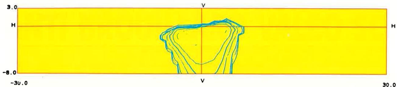
**Faisceau code Surface Complexe sans glace. Seule la coupure est réalisée. L'étalement horizontal sera effectué par les stries de la glace.**
