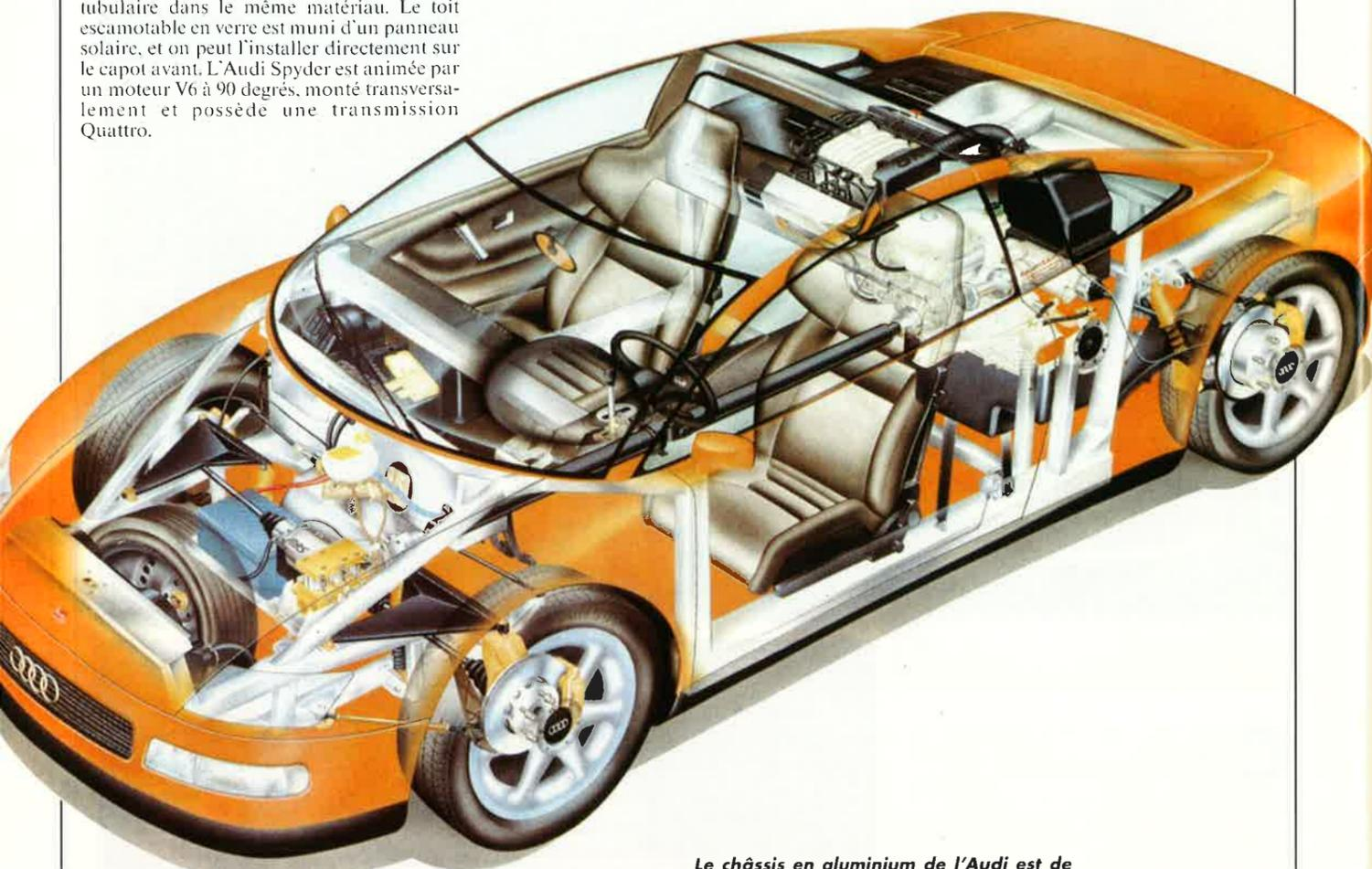
Le châssis en aluminium de l'Audi est de type tubulaire.
