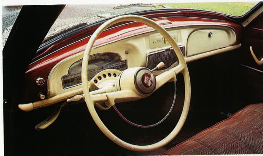
Cette planche de bord appartient à une version Transfluide. Il s'agissait d'un modèle équipé d'une boîte automatique ratée, ce qui ne faisait qu'accroître les insuffisances du moteur.
