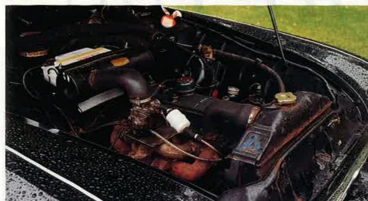
Sous le vaste capot, le spectacle n'était pas tellement réjouissant et cette extrapolation du moteur de la 4 CV ne donna jamais satisfaction.
